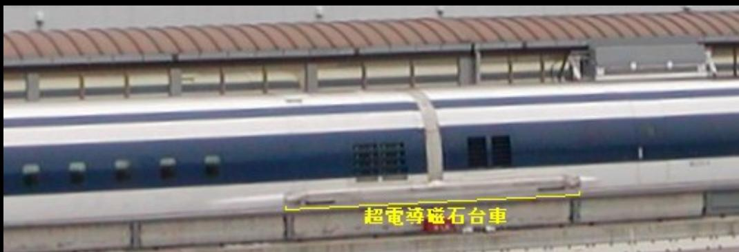
各車両の両端に超電導磁石を配置することで、車両中間部に連続した長い客室を確保出来ます。従来式の配置では、車体長に占める客室の割合が非常に少なくなります。
